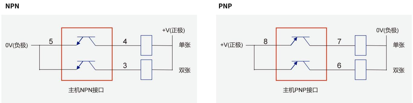
图 3-3: 主机输出接口与继电器接线图
