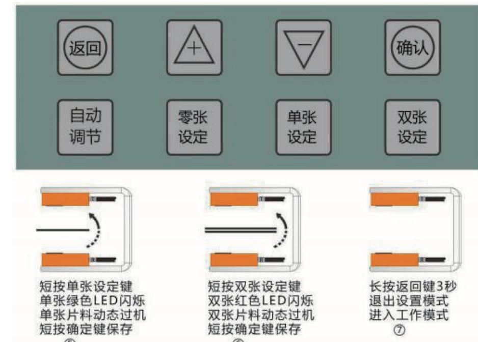
⑤在设置模式下（长按“确定”键3秒），短按“单张设定”键，此时“单张”绿色指示灯闪烁。控制送料系统正常传送一张片料（动态过机），短按“确认”键保存，完成单张动态学习。
