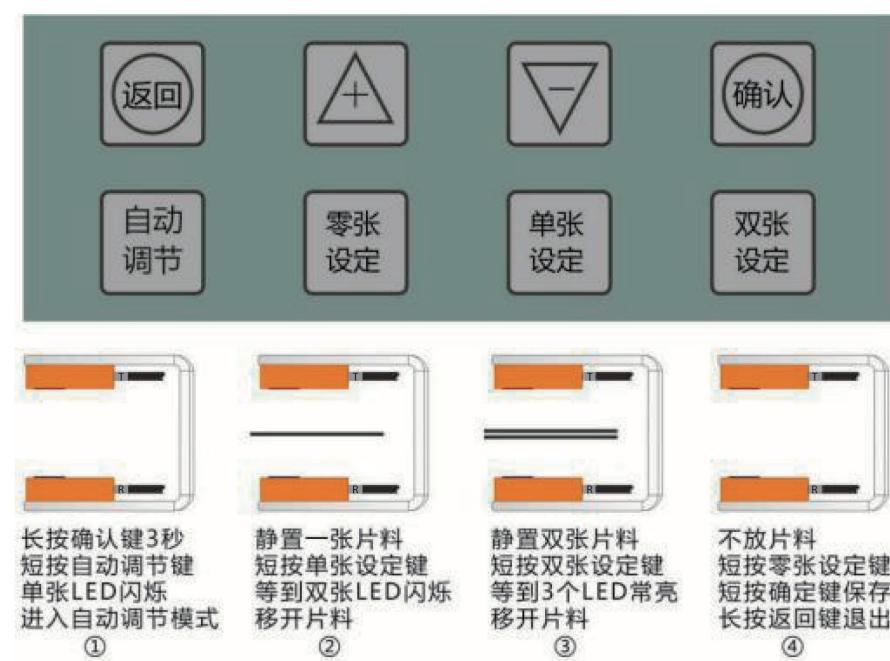
①长按“确认”键3秒，直到液晶屏点亮，进入设置模式，短按“自动调节”键，此时“单张”指示灯闪烁，进入自动调节模式。
