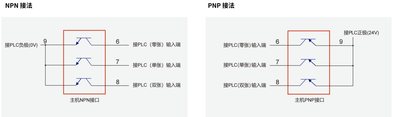
图 3-5：主机输出接口与 PLC 接线图
