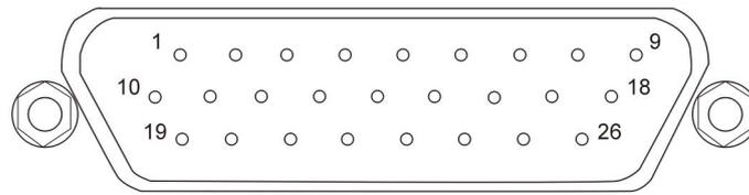
图 2-6: 输入输出接口示意图
