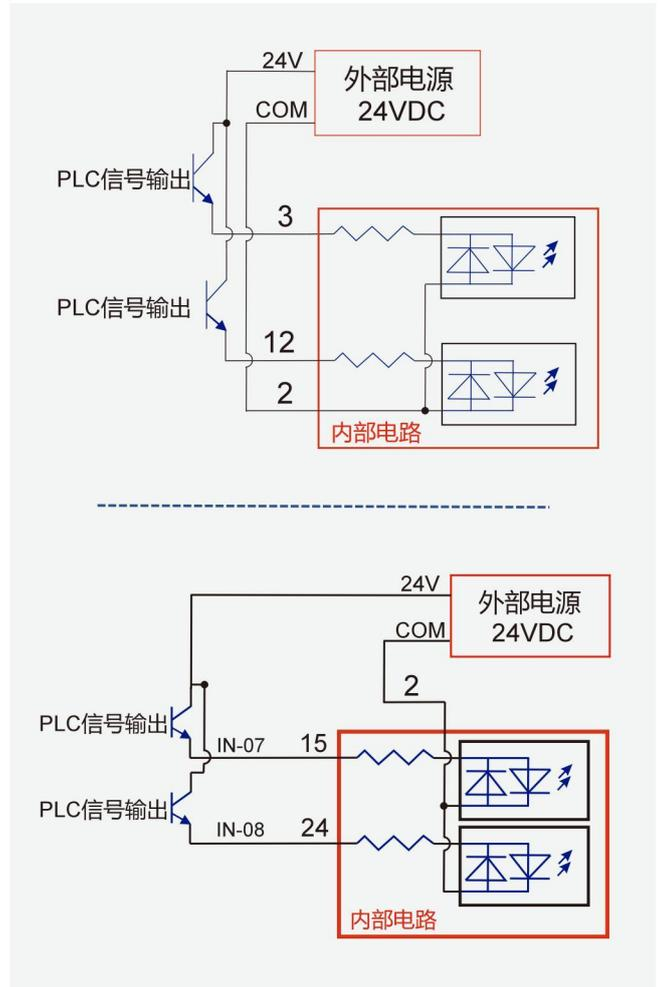
图 2-9: 示教输入 IO 与 PLC 接线图
