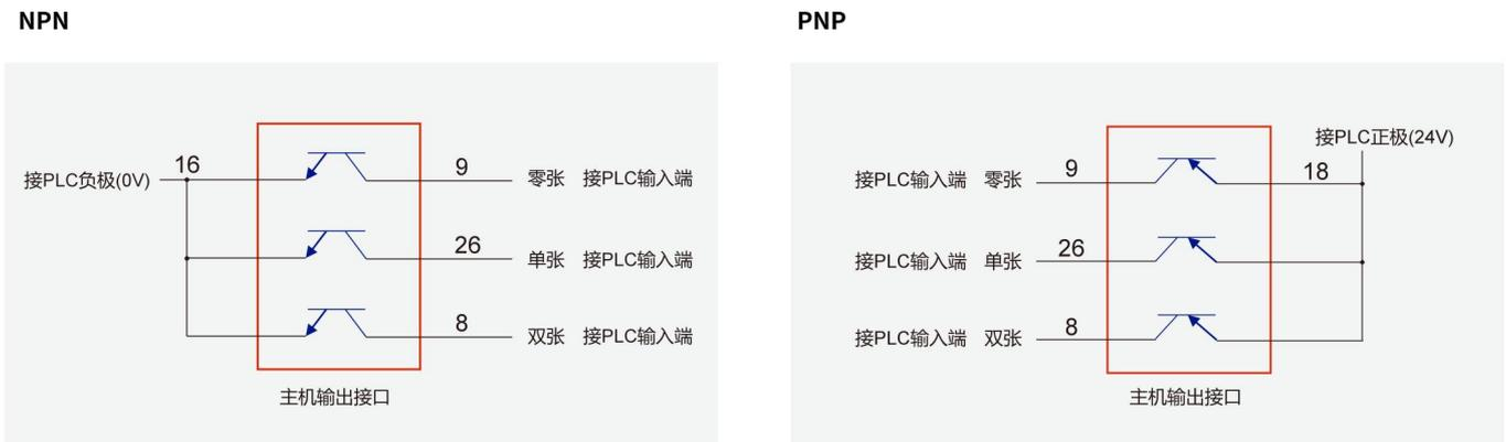
图 2-7：主机输出接口与 PLC 接线图
