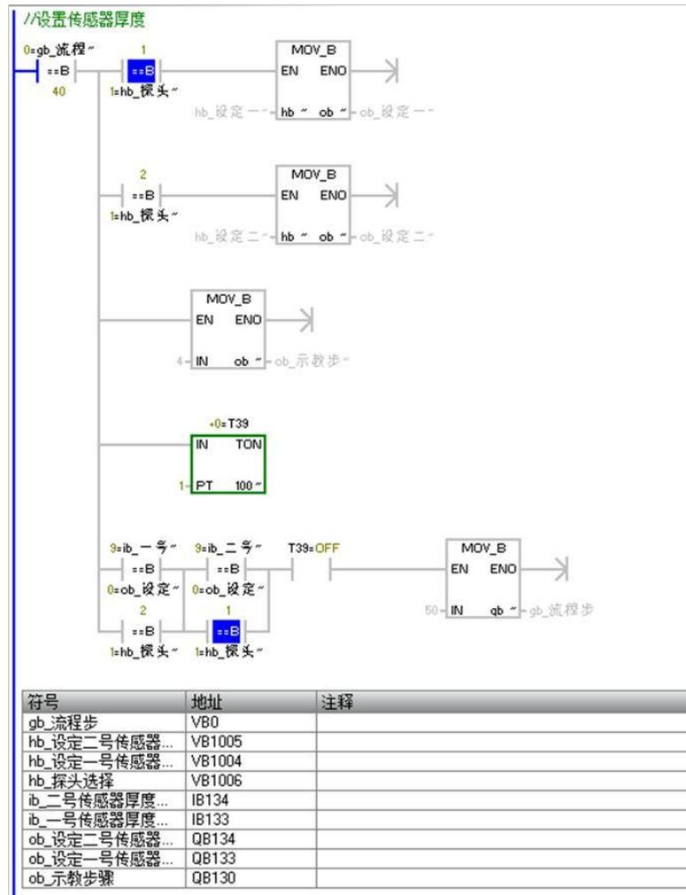
9. 查询传感器厚度：根据第 5 步传感器序号，查询 diAtonm06Sn1thick 或者 diAtonm07Sn2thick 单元值，与写入相等表示设置成功；
