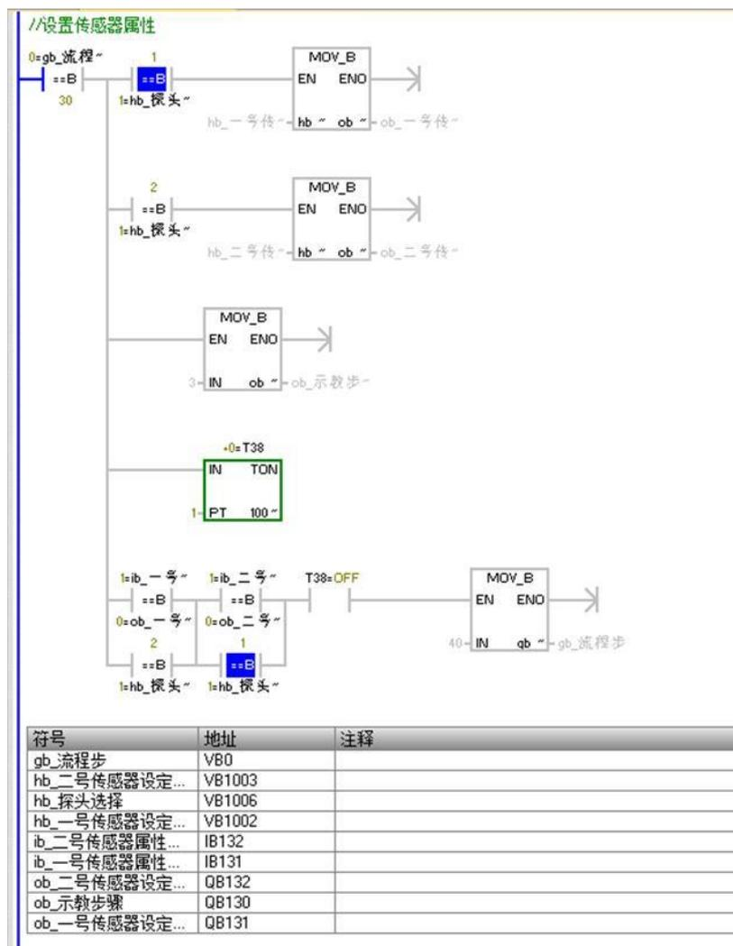
7. 查询传感器属性：根据第 5 步传感器序号，查询 diAtonm06Sn1thick 或者 diAtonm07Sn2thick 单元值，与写入相等表示设置成功；
