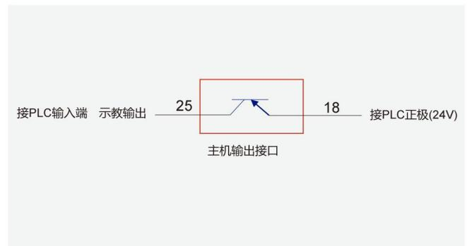
图 2-10: 示教输出 IO 与 PLC 接线图
