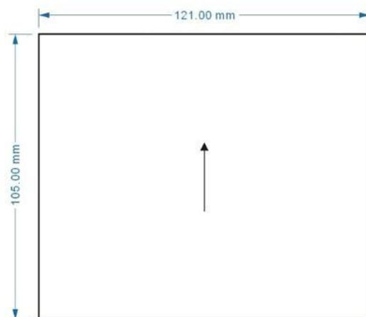
图 1-2: 主机嵌入式开孔尺寸图
