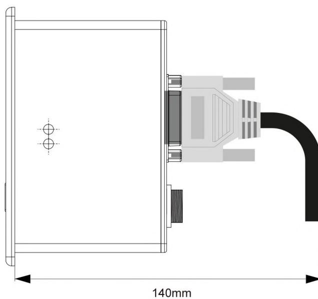
图 1-3: 嵌入式安装深度尺寸图
