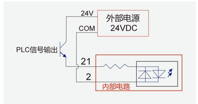
图 2-11: 测量使能信号与 PLC 接线图
