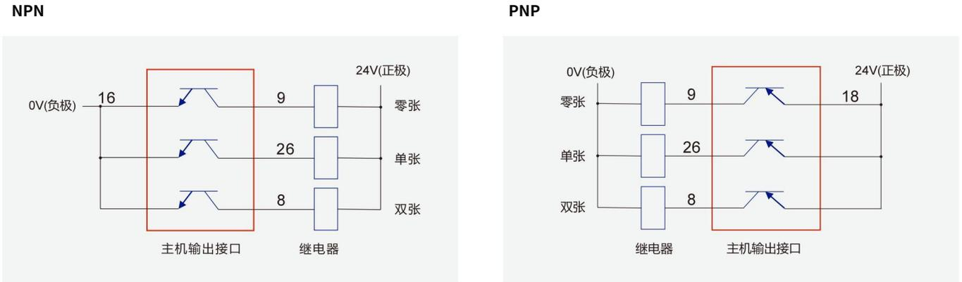
图 2-6：主机输出接口与继电器接线图
