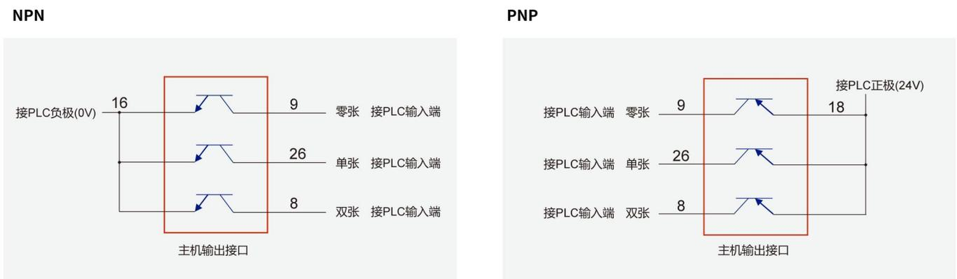
图 2-7: 主机输出接口与 PLC 接线图
