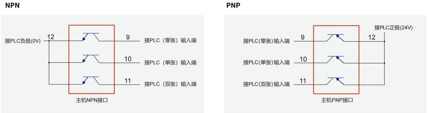
图 3-5: 主机输出接口与 PLC 接线图
