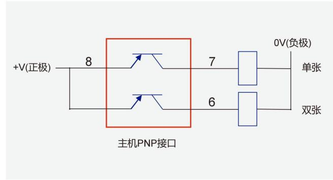
图 3-3：主机输出接口与继电器接线图
