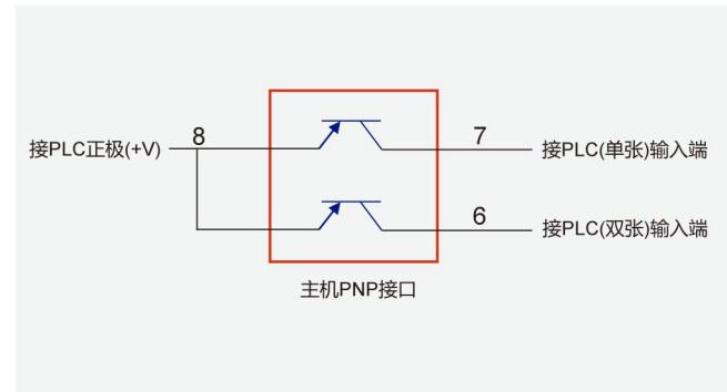
图 3-4：主机输出接口与 PLC 接线图
